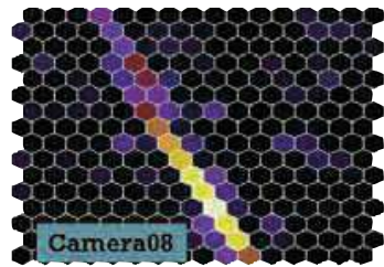
空気シャワー粒子が大気分子を励起して生じる紫外線の解析データ
