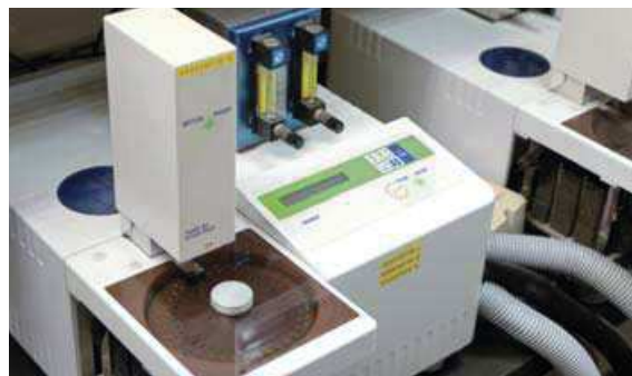
研究室には最新のDSC (示差走査熱測定器) が3台
