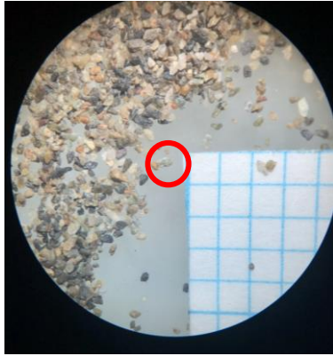
図3：中粒砂内の蛇紋岩（区間C）※1マス 1mm
