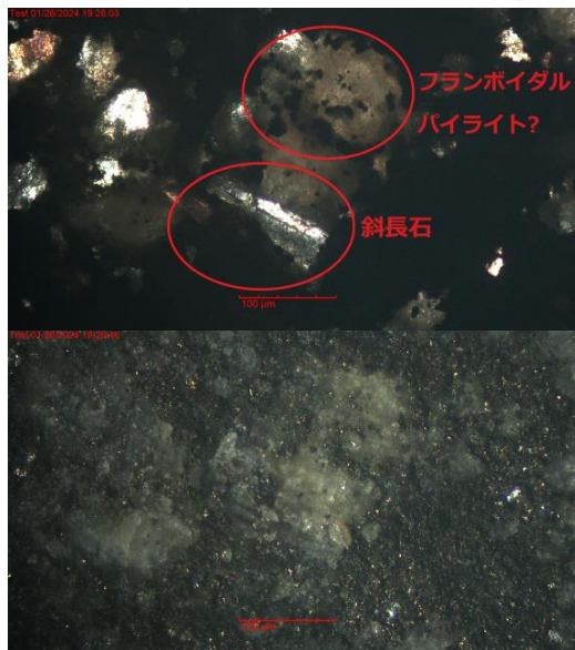
図 5.6 ノジュール薄片に見られた斜長石と黒色の粒(上),金属光沢(下)
