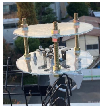
図2. 実際に設置した花粉捕集機.
