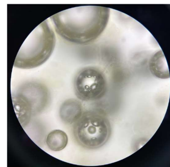
写真 1.作製した O/W/O 型 ME の光学顕微鏡蔵(400 倍)
